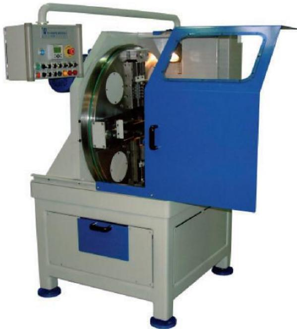
Die einzigartige ABM-6 Maschine hat sehr kurze Bearbeitungszeiten im Vergleich mit einer konventionellen Bandsäge oder Kreissäge. Die ABM-6 ist bis zu 20 mal schneller. Nicht nur die Bearbeitungszeit ist kürzer. Auch die Behandlung vom Material wird extrem vermindert weil zwei Bearbeitungen (Trennen UND BEIDseitig Anfasen) gleichzeitig ausgeführt werden. Dieses sorgt für ein enormes Zeitgewinn.
