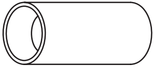
Innen-Taper (verschiedene Winkel und gleichzeitig Planen möglich)
