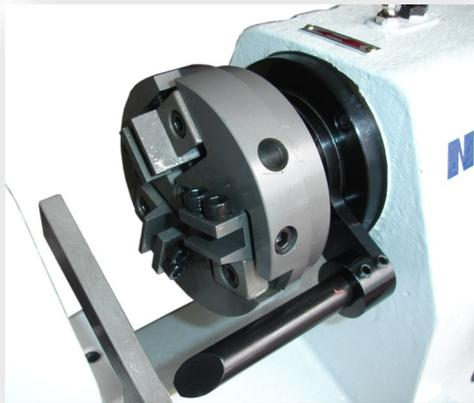
In die Maschine wird ein Drehkopf verwendet, der mit 3 Nuten ausgerüstet ist. Hierin kann man ein bis drei Wendeschneidplattenhalter montieren. Diese Halter werden je ausgerüstet mit einer hartmetallenen Wendeschneidplatte.
