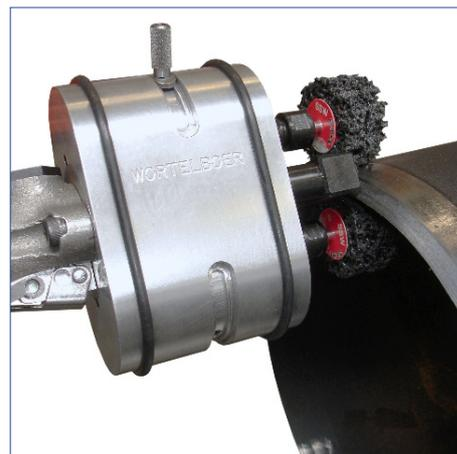
Die auswechselbare Schleifmoppen sind Standard lieferbar in Durchmesser 30 und 50 mm. Die Schleifbreiten sind Standard 20 und 30 mm. Die Standard Körne der Moppen sind 40 und 80. Die Schleifmoppen haben ein hochwertiges Korn von Alu-Oxid. Zirkonium Schleifmoppen sind auch lieferbar für spezielle Zwecke.
