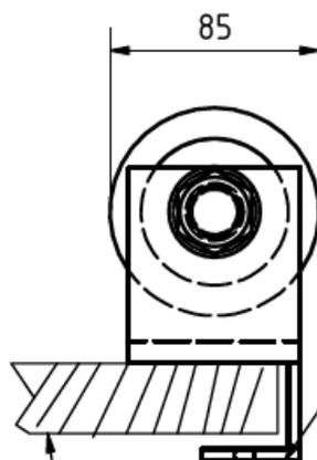
WINKELPROFIL ZUR KLEMMUNG DURCH KLEMMSCHRAUBEN AUF FLANSCH DES TRÄGERS
